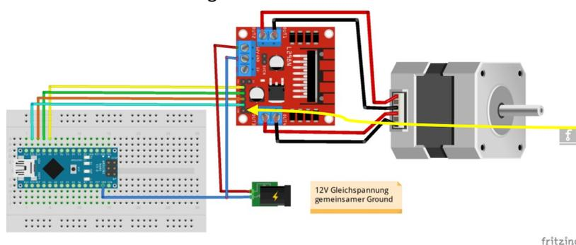
Nicht wirklich spektakulär, aber eben mit externer Stromversorgung ab 12V aufwärts. Bei Spannung > 12V muss der Jumper entfernt werden!
